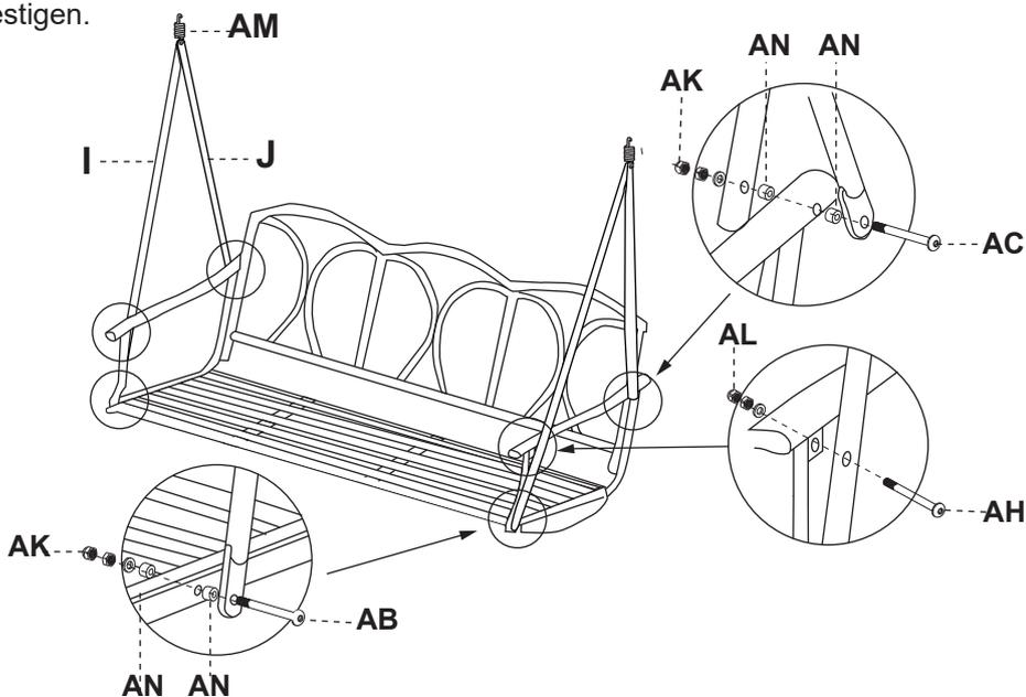
6. Schaukelstangen #J #I mit den Balken #A #A1 durch die Federn verbinden.
