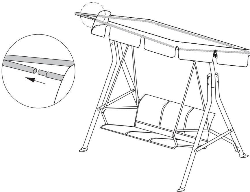
— Verbinden Sie die Seitenstangen #K mit den Dachstangen #L im Dach.
