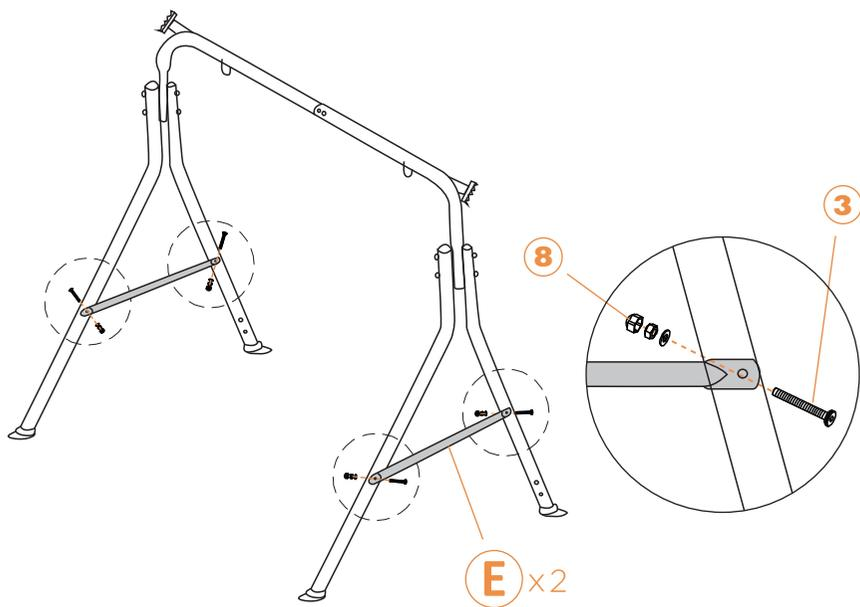
— Verbinden Sie die Beinstangen #E durch M6\*50mm-Schraubensets(③) und Muttern(⑧) mit den Beinen(vorn) #A und den Beinen(hinten) #B.
