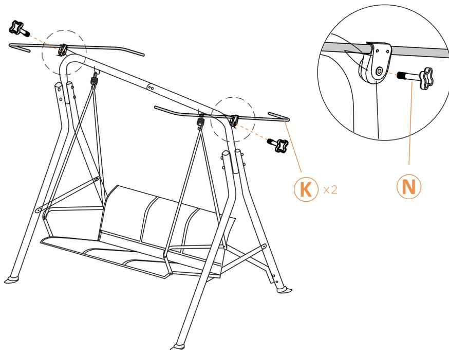
— Verbinden Sie die Seitenstangen #K durch die Befestigungsknöpfe #N mit den Balken #C, #D.
