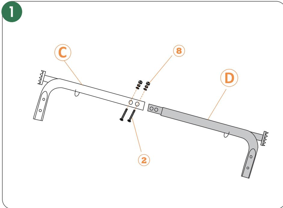
■ Verbinden Sie den Balken(links) #D durch M6\*45mm-Schraubensets(2) und Muttern(8) mit dem Balken(rechts) #C.
