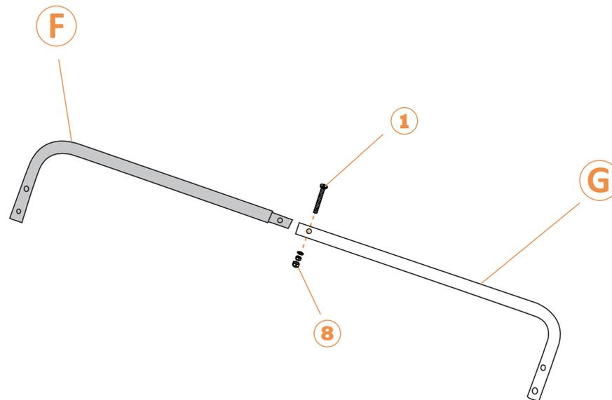
— Verbinden Sie die Rückenstange(rechts) #F durch M6\*30mm-Schraubensets(①) und Muttern(⑧) mit der Rückenstange(links) #G.
