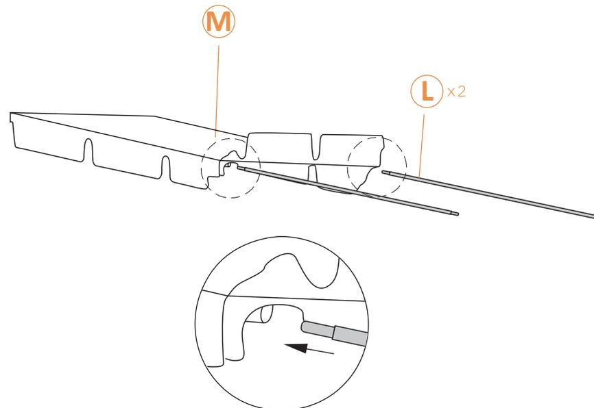
— Setzen Sie die Dachstangen #L in die Rohren auf den beiden Seiten des Daches #M ein.
