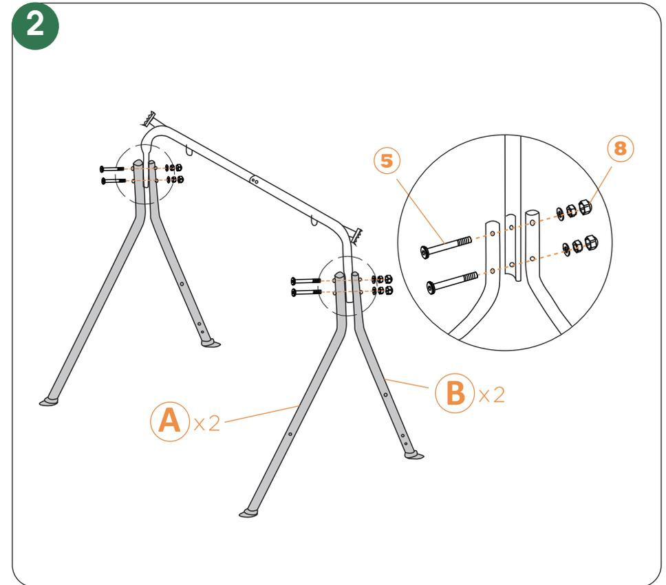
■ Befestigen Sie die Beine(vorn) #A und die Beine(hinten) #B durch M6\*90mm-Schraubensets(5) und Muttern(8) an den Balken #C, #D.
