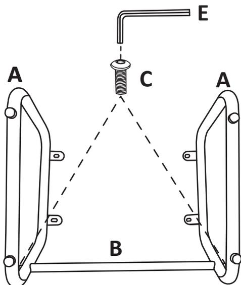
Verbinden Sie die Beine **#A** mit die Stange **#B** zusammen. Befestigen Sie sie mit Schrauben **#C**.
