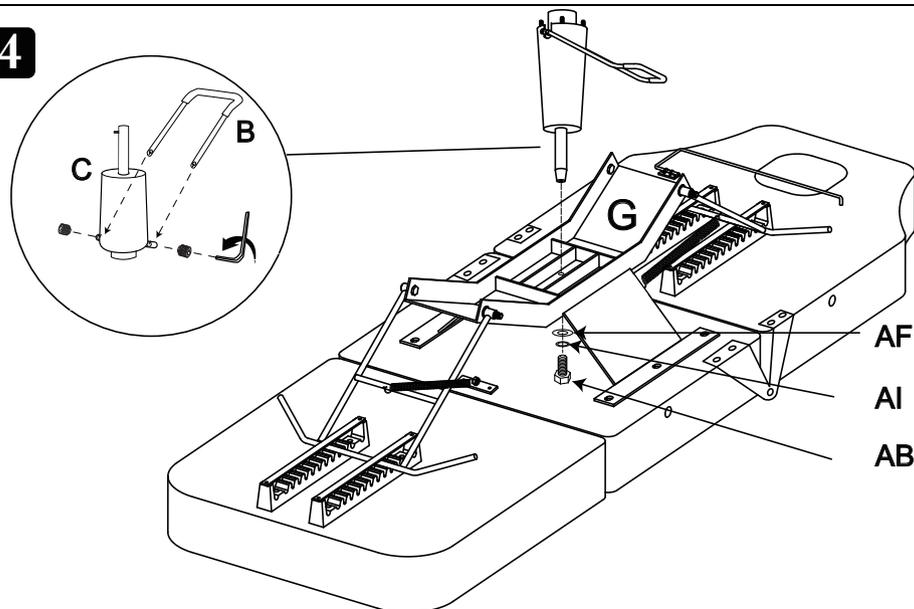
4.1 Befestigen Sie den Hebel (B) mit den vorinstallierten Schrauben an der Pumpe (C).
