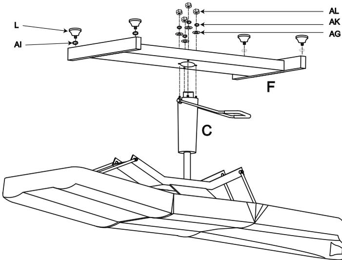
5.1 Befestigen Sie die Pumpe (C) mit Schrauben (AG/AK/AL) an die Basis (F).
