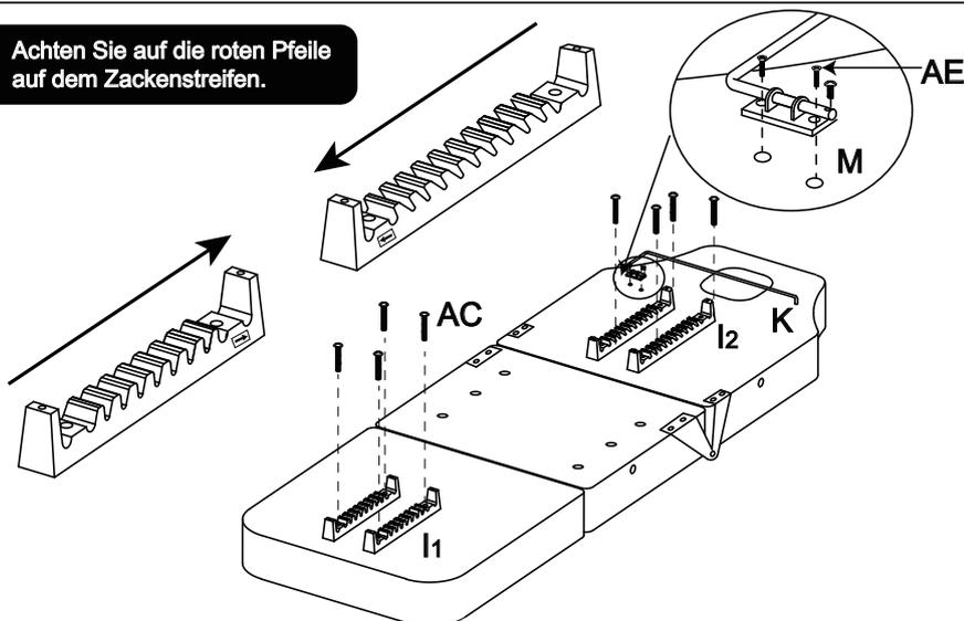
1.1 Befestigen Sie die kurze Zackenstreifen (l1) an der Beinstütze und die lange Zackenstreifen (l2) an der Rückenlehne mit Schrauben (AC).
