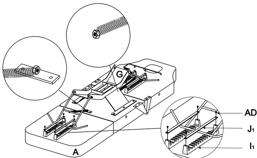
3.1 Legen Sie die T-Balken (H1/H2) zwischen die Zackenstreifen (I1/I2) und befestigen Sie die Aluminiumblech (J1/J2) mit Schrauben (AD) daran.
