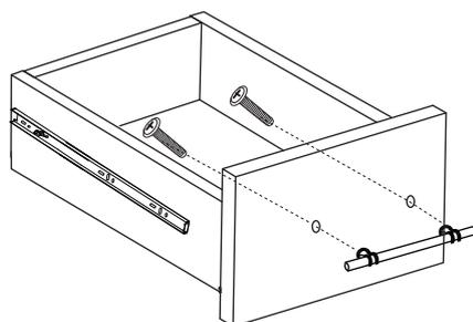
Bitte schrauben Sie die Griffe, die für einen sicheren Transport an der Vorderseite der Tür umgedreht sind, ab und schrauben Sie sie wieder in der richtigen Position fest, wie abgebildet.
